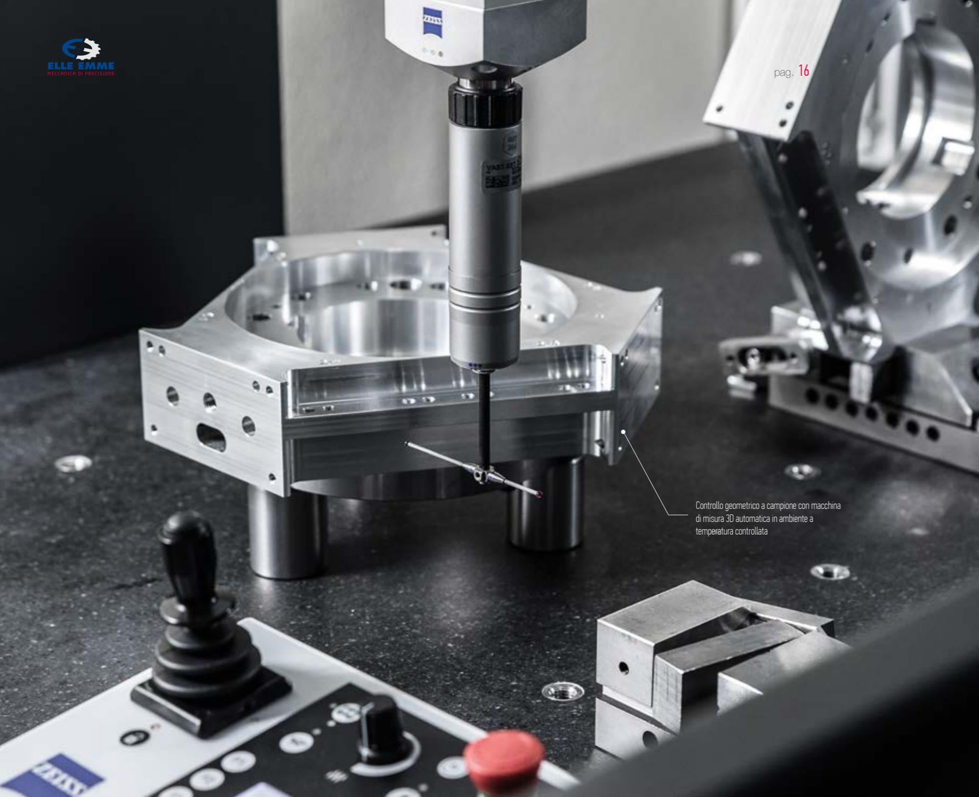
Controllo geometrico a campione con macchina di misura 3D automatica in ambiente a temperatura controllata
