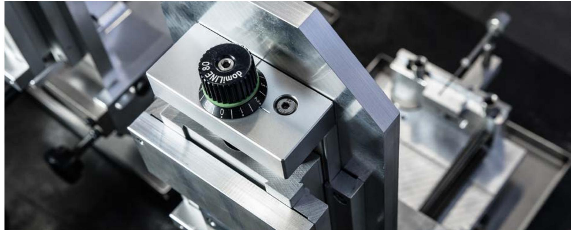
Indotto di magnetizzazione: la complessità di lavorazione di un particolare non risiede solo nella sua geometria ma anche in eventuali elementi a sbalzo. In questi casi è determinante l'esperienza nell'approccio di fresatura per evitare vibrazioni.
